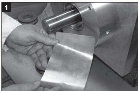
1 Corte um cunho de latão de 0,13 mm (0,005") de espessura em um comprimento 6,3 mm (¼") maior que a circunferência do eixo.
